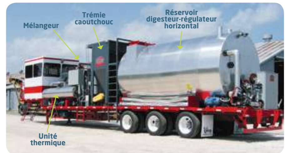
Figure 16. Unité de fabrication avec mélangeur et réservoir digesteur
