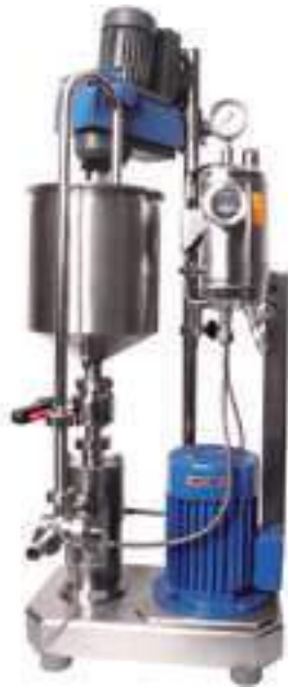
Figure 12. Unité pilote pour la fabrication de bitume-caoutchouc
