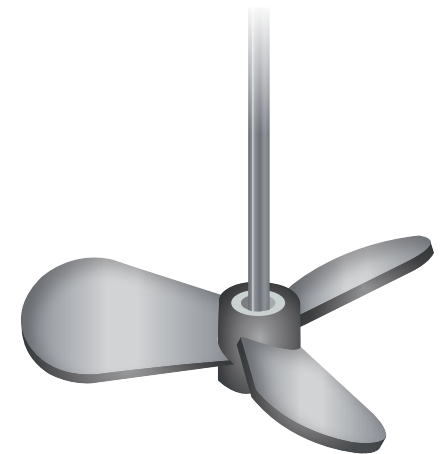
Figure 7. Tête d'un mélangeur à hélice
